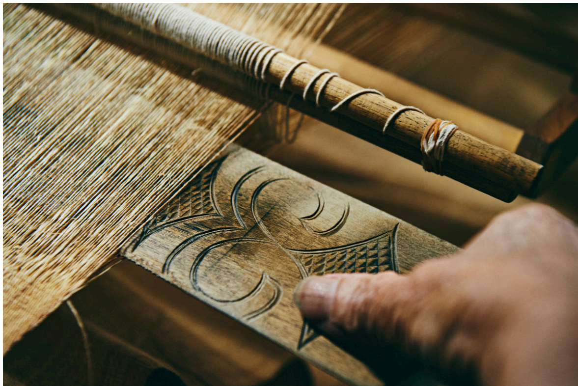
(上) 綜統棒の手前、糸が上下に分かれたところにペラを差し込んで隙間を広げ、そこに緯糸を通し、ペラを倒して打ち込む。アットゥンを織るときは、経糸緯糸ともに水で濡らしながら織る。湿らせた状態の方が打ち込む際に糸に負担がかからず、織り上がりが締まるからだ。
